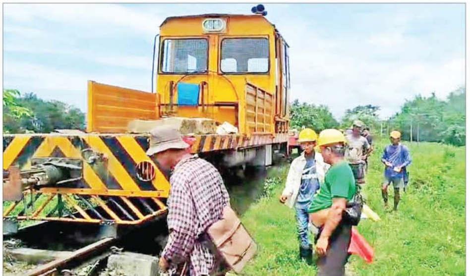
ပဲခူး-မော်လမြိုင် ရထားလမ်းပိုင်းအတွင်းရှိ သိမ်ဆိပ်နှင့် ဒုံဝန်းဘူတာအကြား မိုင်တိုင်အမှတ် (၁၂၁/၂၀-၂၁)ကြားရှိ ရထားလမ်းပိုင်းအား ပြန်လည်ပြုပြင်ပြီးစီး၍ RGC ဖြင့် စစ်သပ်မောင်းနှင်နေစဉ်။
